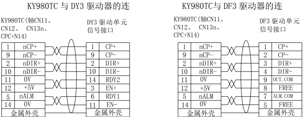
图 2-11 KY980TC 与驱动单元的连接
