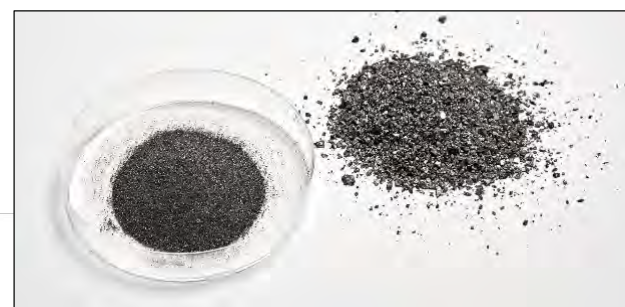
使用行星式球磨机 PULVERISETTE 5 加强型研磨铁钒之前和之后的情况
