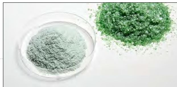
使用微型行星式球磨机 PULVERISETTE 7 加强型研磨玻璃之前和之后的情况
