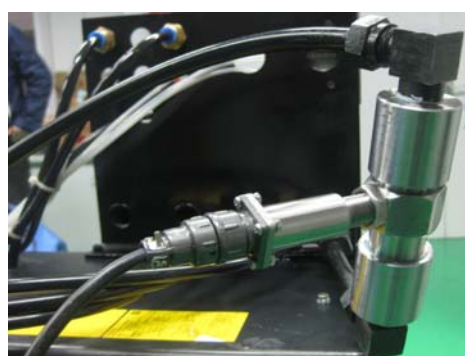
图 8d 进出油口温度测试
