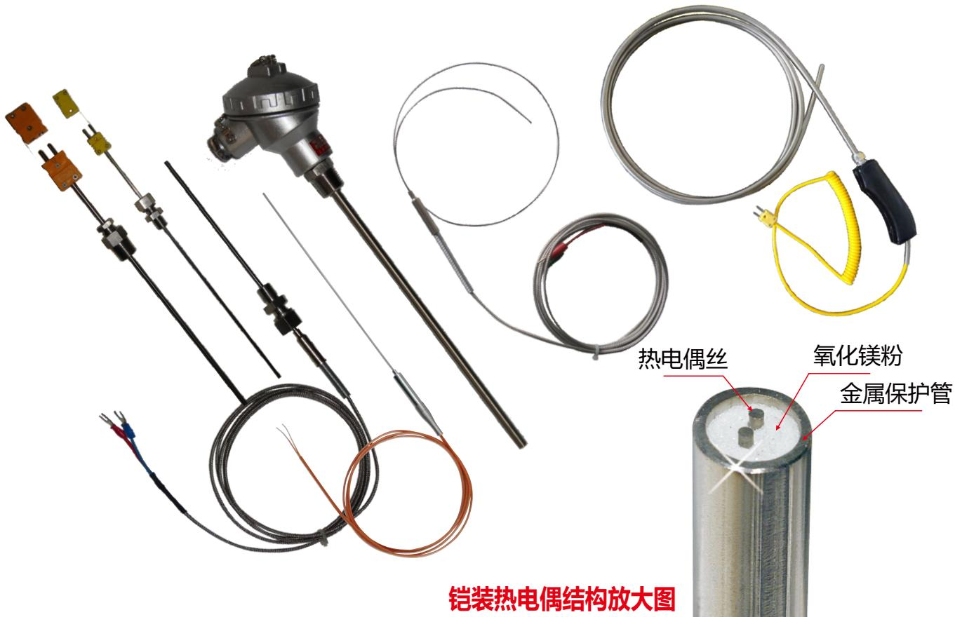
铠装热电偶电缆是将偶丝穿在矿物绝缘材料氧化镁套柱内后一起装入金属保护套管里，经多道次压缩减经退火加工成可弯曲的坚实组合体，是制造铠装热电偶的关键基础材料，它们广泛应用于需要测温的各个工农业部门和科技领域。
