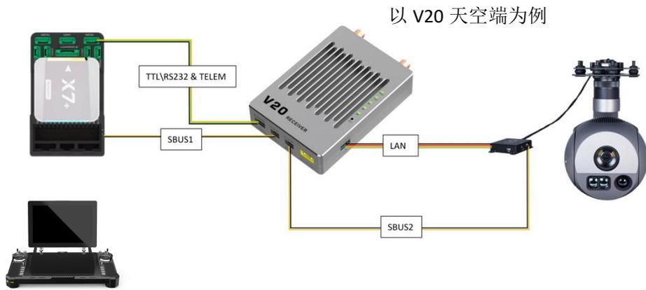
方式二：集成链路多吊舱连接
