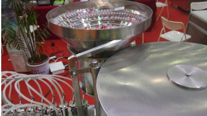
(5)、轧盖采用三刀式柔性轧盖头，定位中心正确，轧好的瓶子美观、轧紧，铝盖端正，无假锁、翘边、歪盖现象，达到锁口部位光滑、平整，无毛刺、豁口、褶皱，铝盖无转动，具有缺瓶不下盖、不轧盖功能，达到产品合格率符合要求，提高了产品的质量。
