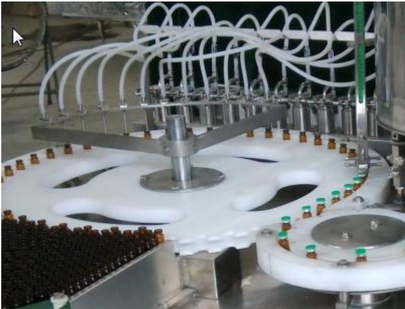
(4)、铝盖振动盘及轨道采用不锈钢材质（304）制作，可方便拆卸灭菌。理盖振动工位可快速拆装设计，可灭菌。
