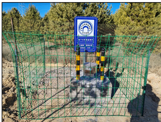
地下水监控井
