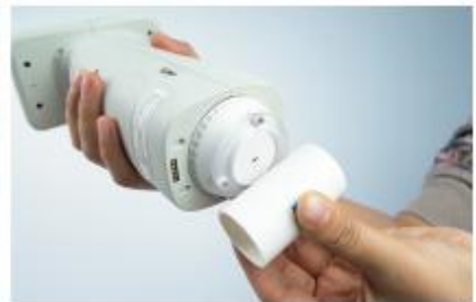
小口径测量曲面物体颜色
