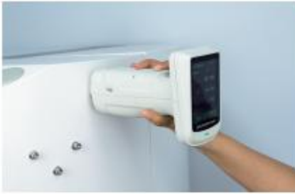
测量金属喷涂颜色
