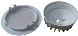
灯具塑料外壳激光焊接
