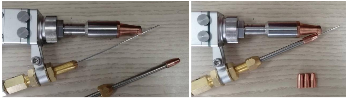
图 4.7 送丝管与焊接头组装
