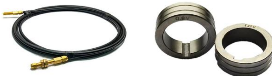
图 4.6 送丝管、送丝轮示意图
