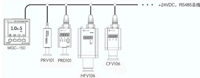
WGC控制仪与infitech系列真空计直接连接使用，可以同时连接四个相同或者不同型号的真空计。
