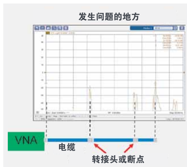
图 16. VNA 以数学方式把扫频测量转换到时域。可以使用这一测量来定位线路中的阻抗不匹配或问题。
