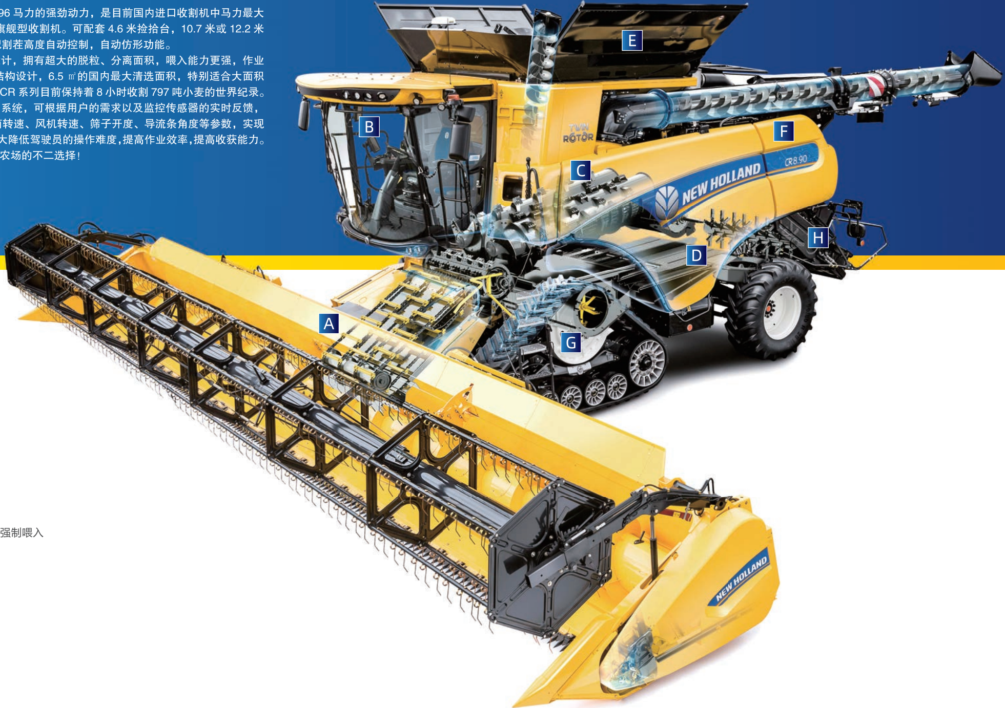
740CF（35 英尺）谷物挠台 10.7 米幅宽，塑胶弹齿，标准分禾器
