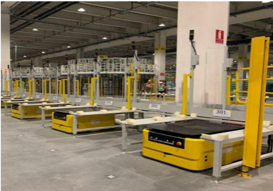
自动导引小车（AGV）：用于与提升机对接及物料运输
