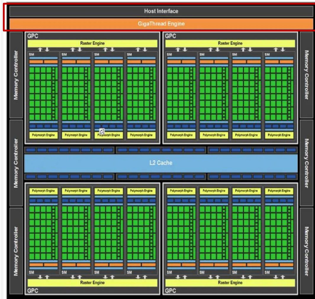
Fermi核心微架构
