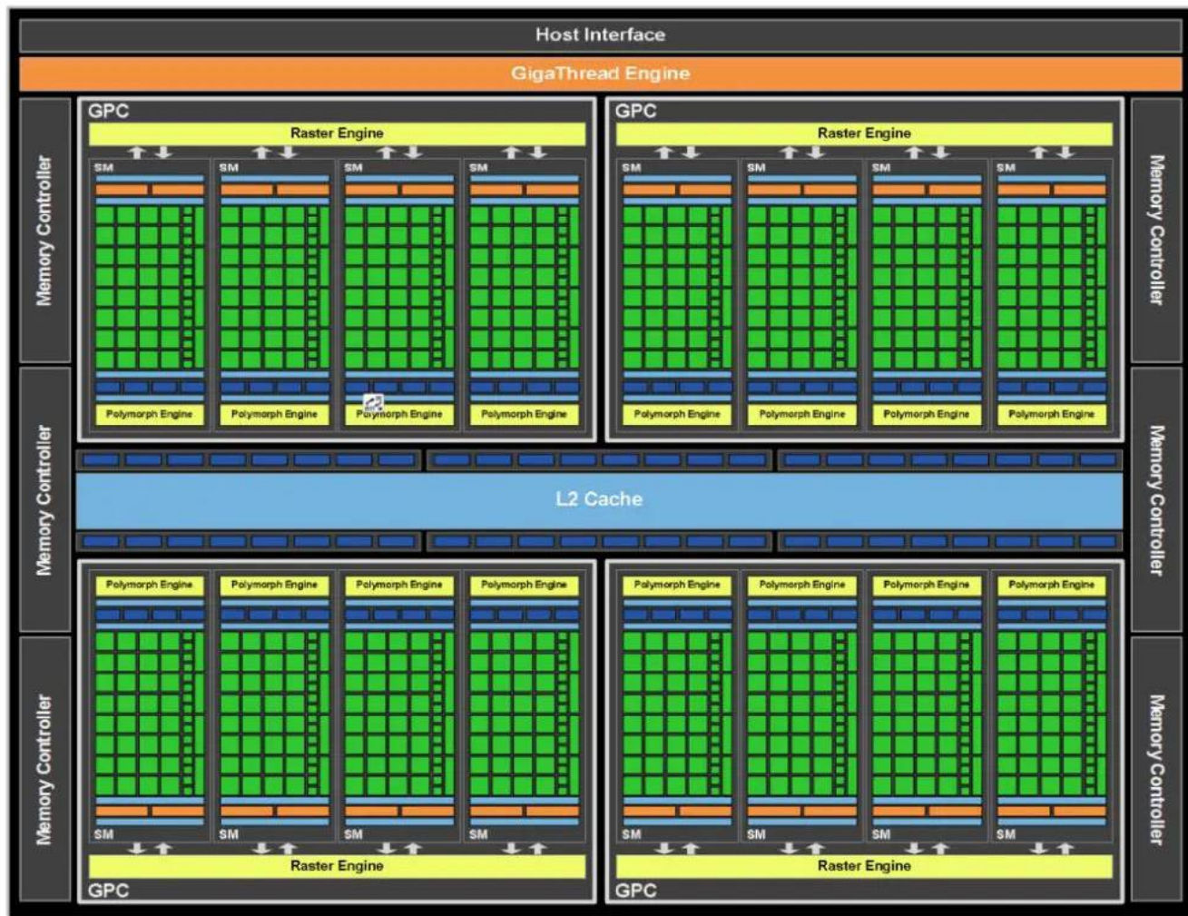
Fermi核心微架构
