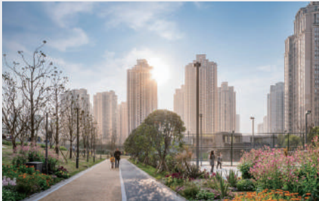
采用透水沥青铺装的健身步道
