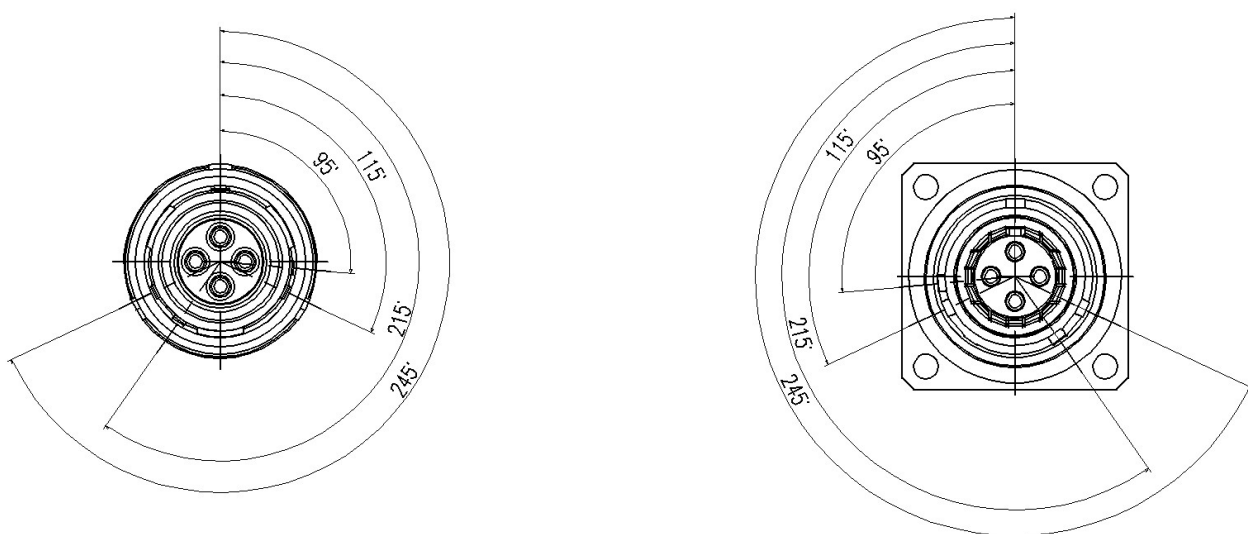
后装24型插座插合尺寸图
