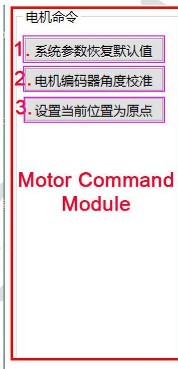
1. 系统参数恢复默认值-System Parameters Restore Defaults: The motor parameters restore system default values.
