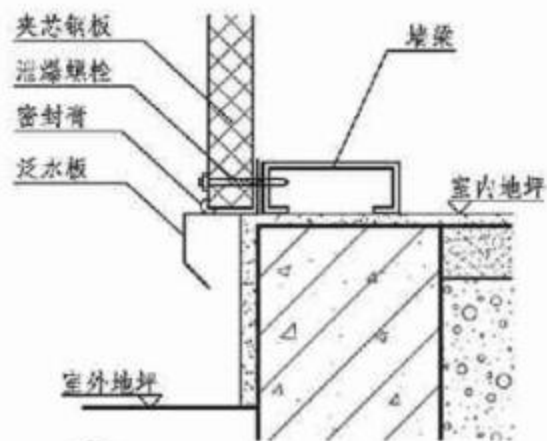
① 外挂式泄爆墙底部泛水
