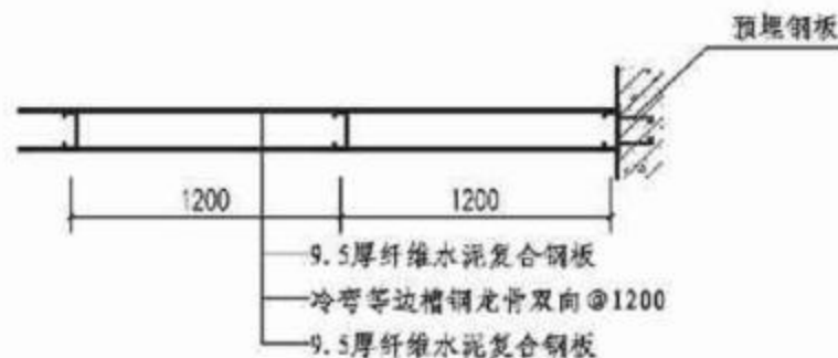
2 无吊杆支撑的抗爆吊顶做法
