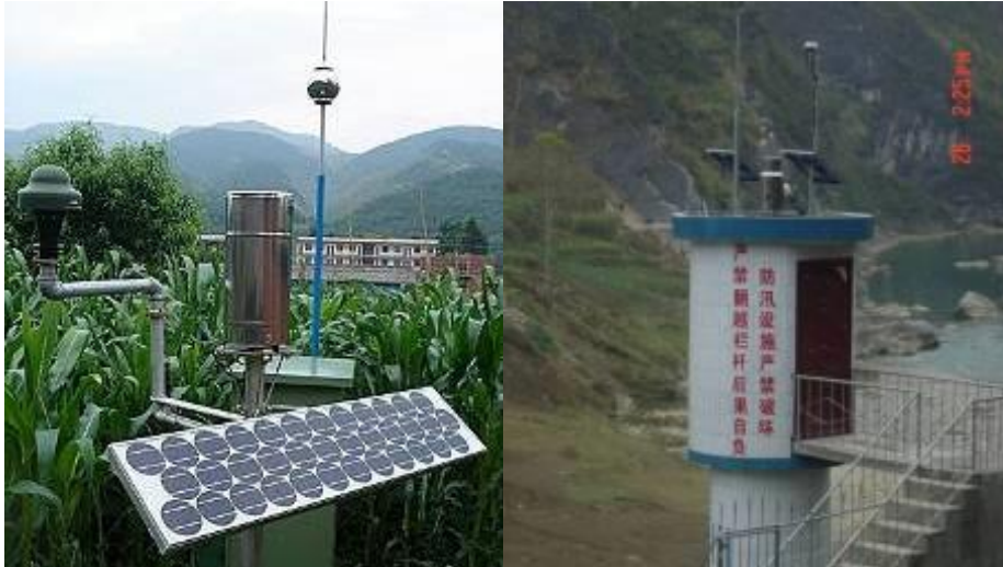
基于北斗 RDSS 短报文的的水利监测装置
