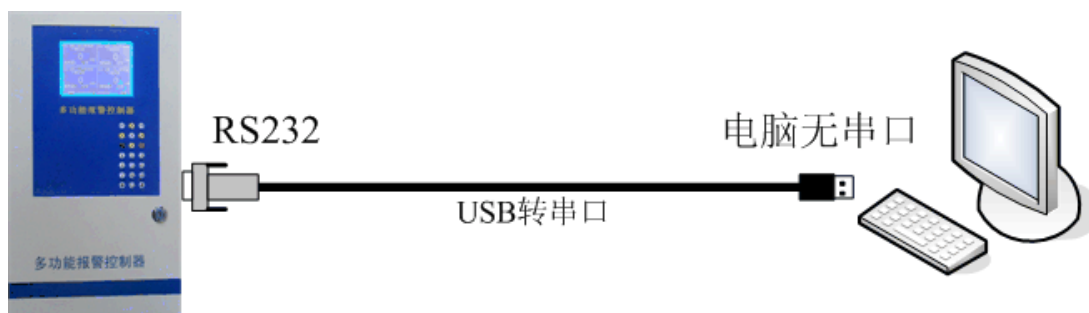
图 2 RS232 使用 USB 转串口
