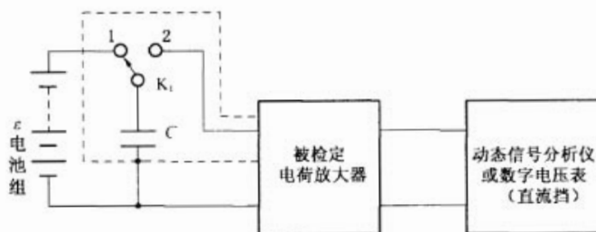
图 6 A 类电荷放大器等效下限频率的检定接线图
