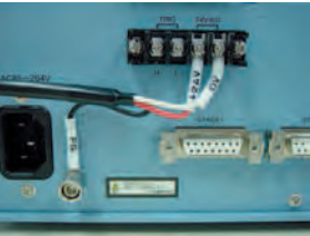
平台控制器侧的接线例
