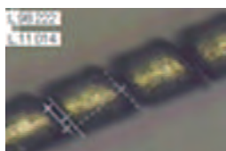
铜线上的螺旋槽加工
