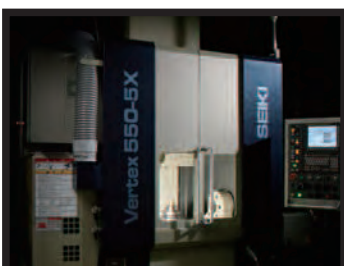
5轴控制立式加工中心
