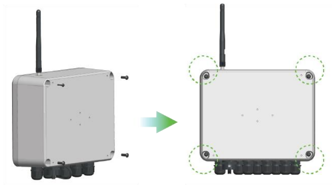
图 3-6 壁挂式 F351x 安装步骤 02
