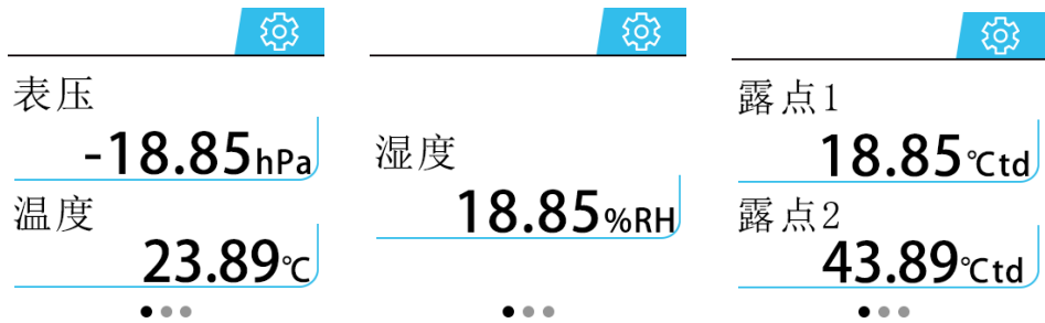
图 4-3 F191x 温度、湿度、露点等数据界面
