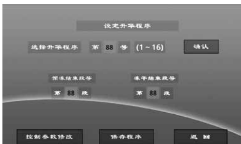
图 4 设定升华程序界面
