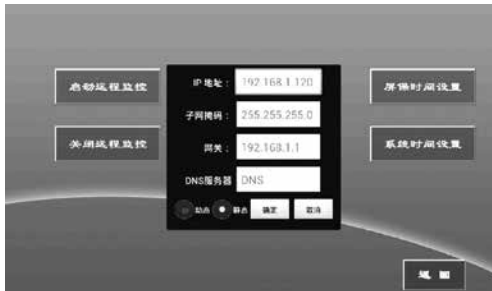
图 17 设备 IP 静态地址设置
