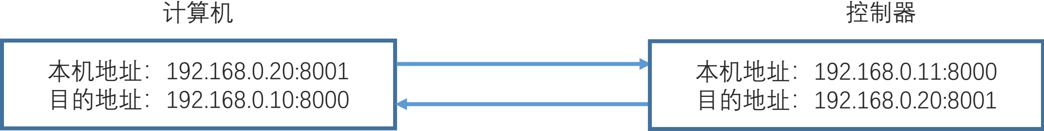
图 1、计算机打算进行通信的控制器IP地址与控制器实际地址不一致
