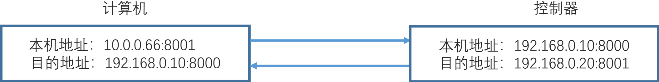
图 2、控制器打算进行通信的计算机IP地址与计算机实际地址不一致
