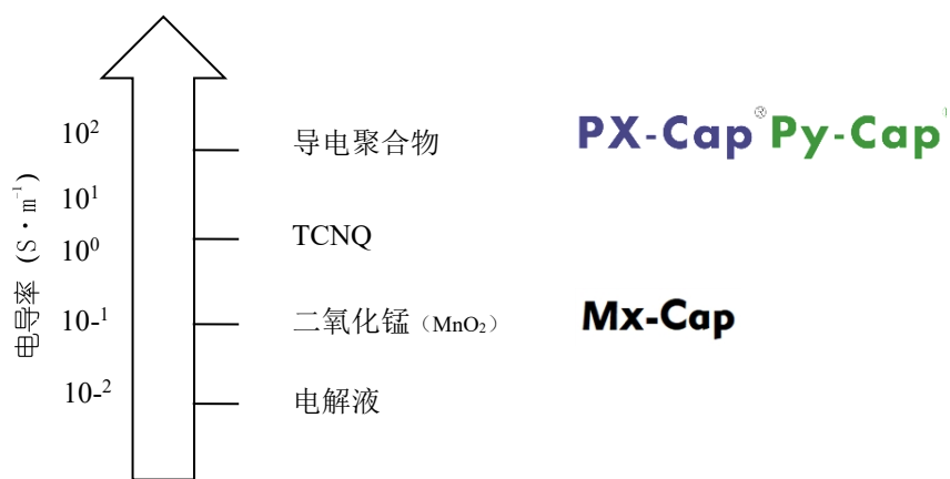
图 2. 典型电容器电解质电导率图
