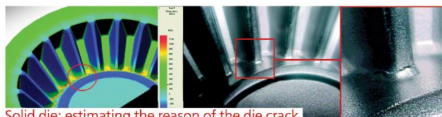
评估模具裂纹发生的原因
