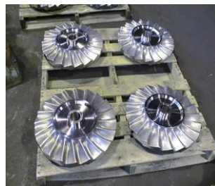
航空航天 Ti 合金零件 采用旋转对称方式建模计算
