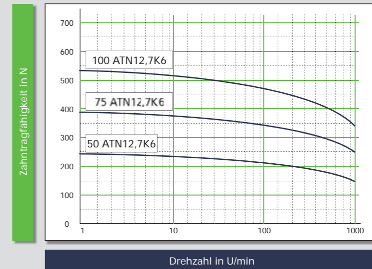
ATN12,7K6 / ATN12,7K6 DC - Zahntragfähigkeit F_{Uspez} pro eingreifenden Riemenzahn in N
