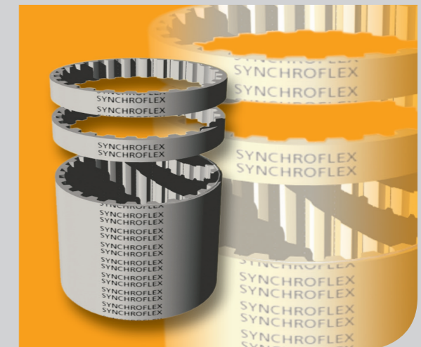
准备脱模的同步带套筒，其中部分分离为几个皮带
