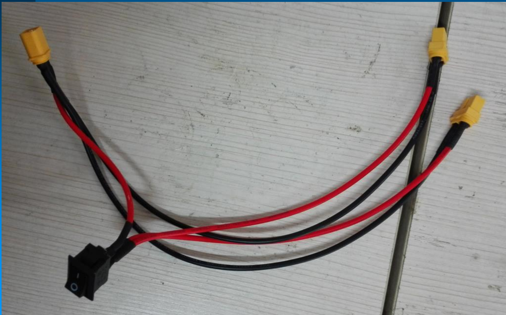
7/10 生命柱输出端（接控制电路）的一分二转接线
