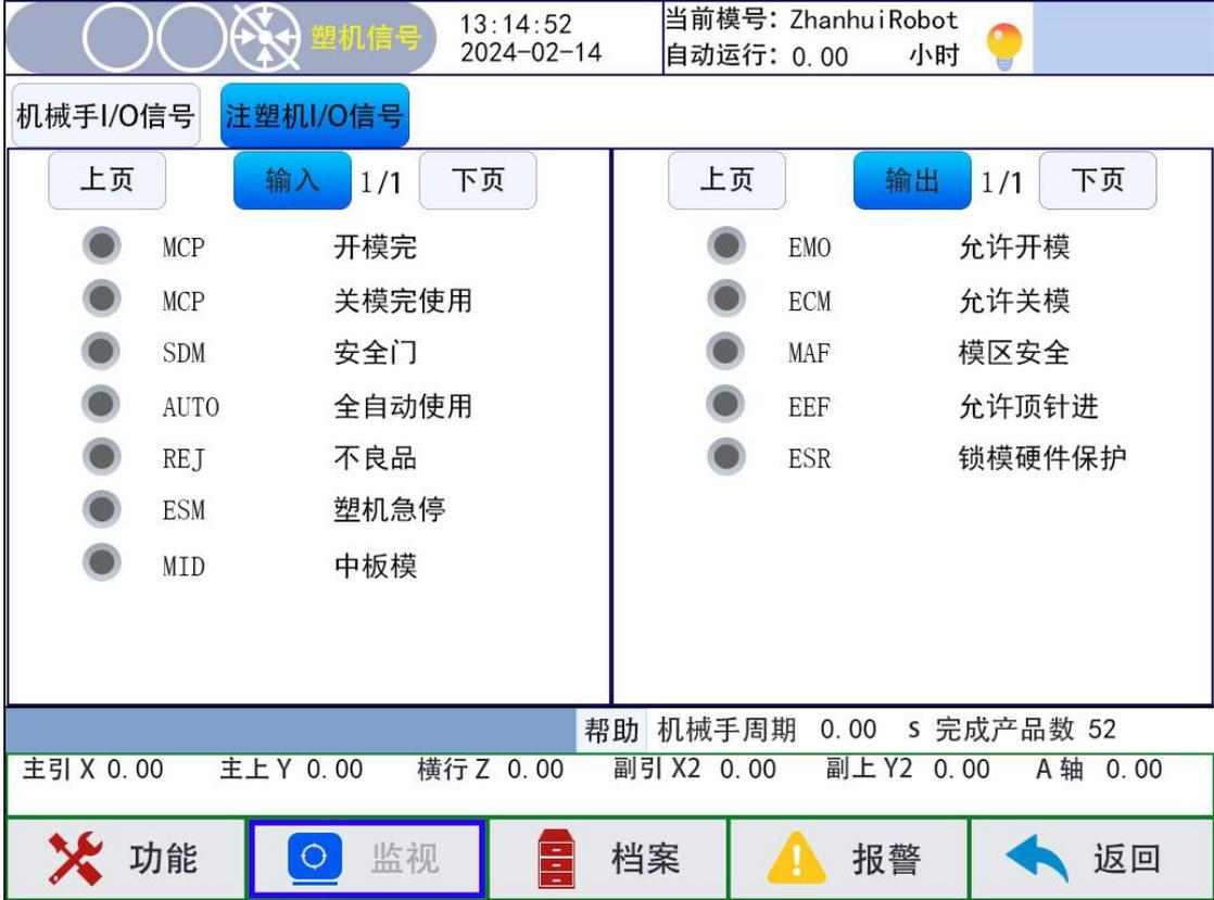
该界面展示了注塑机的 I/O 信号监视。顶部状态栏包含时间、日期、当前模号及运行时间。主区域分为机械手 I/O 信号和注塑机 I/O 信号两部分，每部分均有“上页”、“下页”和“输入/输出”控制按钮。底部显示了机械手周期、完成产品数及轴位置等实时数据。底部导航栏包含功能、监视、档案、报警和返回按钮。
