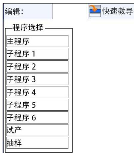
如图所示，最多可选择编辑六个子程序及试产及抽样程序，教导方法与主程序相同，并且这些程序可以被主程序所调用执行。
