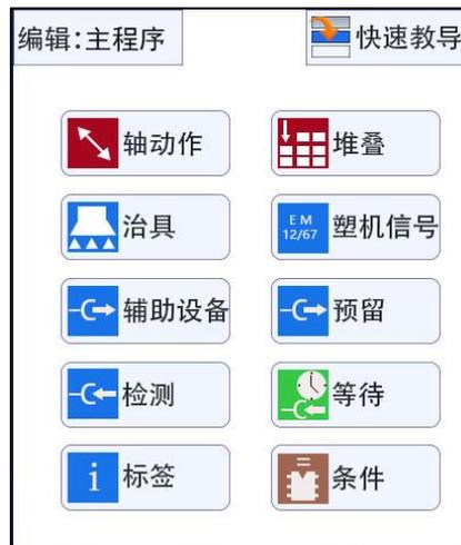
系统目前提供指令有：1.轴动作指令、2.治具指令、3.辅助设备、4 检测、5 标签、6 堆叠、7 塑机信号、8 预留、9 等待、10 条件。主程序子程序及快速教导。
