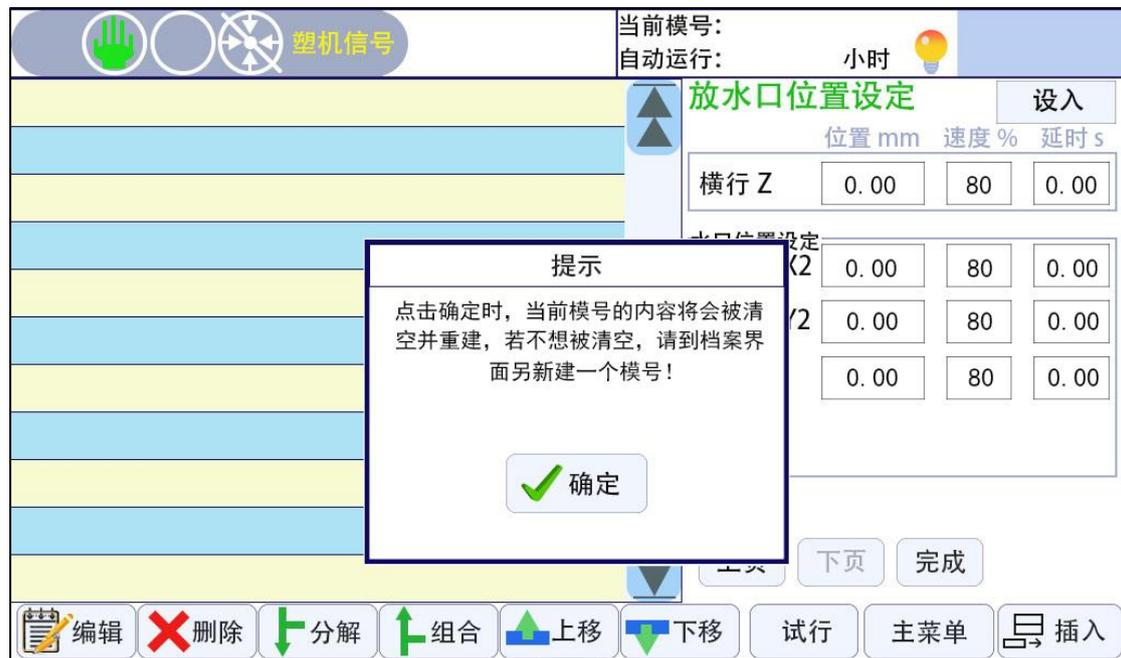
1.若按下“确定”按钮，左侧已生成的程序将全部删除，并按快速教导的设定与相关参数将生成一套完成的程序；否则，按“取消”按钮关闭提示窗口不做任何改变。
