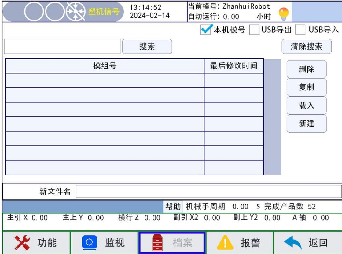
将操作器选择按钮旋转至停止状态，点击界面下方的档案按钮即可进入模号管理页面。
