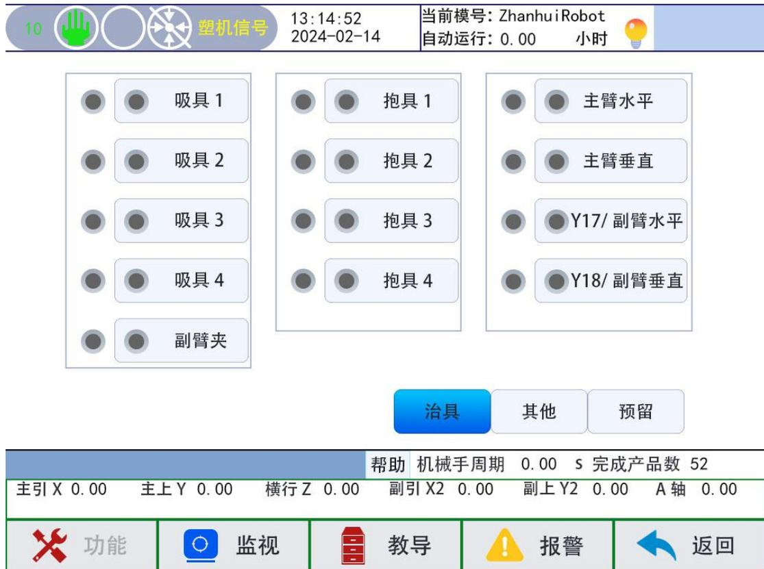
点击屏幕上对应的按钮 **治具**，电机对应的功能按钮，可控制对应的 IO 输出。
