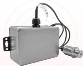
消防水压、水位监测
