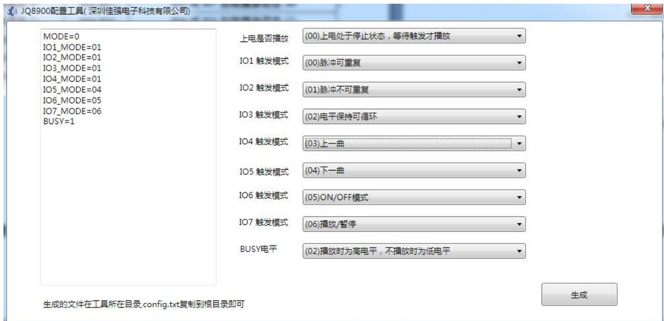
对每个 IO 口进行配置好后，点生成，就自动在配置工具所在目录生成了一个 config.txt 文件，然后将 config.txt 文件复制到存储器里即可。
