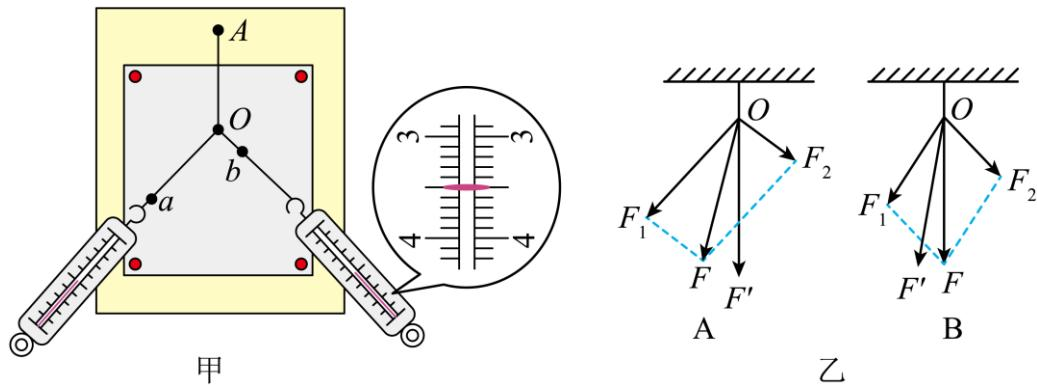
(1) 某次实验中, 弹簧秤指针位置如图甲所示, 其读数为\_\_\_\_\_ N; 实验中用  $Oa$ 、 $Ob$  确定两分力方向, 其中标记不妥的是\_\_\_\_\_ (填 “ $a$ ” 或 “ $b$ ” ) 点。
