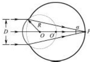
(3) 人的眼球可简化为如图所示的模型. 折射率相同、半径不同的两个球体共轴. 平行光束宽度为  $D$ , 对称地沿轴线方向射入半径为  $R$  的小球, 会聚在轴线上的  $P$  点. 取球体的折射率为  $\sqrt{2}$ , 且  $D = \sqrt{2}R$ . 求光线的会聚角  $\alpha$ . (示意图未按比例画出)
