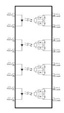
1.3.5.7 LED Anode 2.4.6.8. LED Cathode 9.11.13.15. Drain(MOS FET) 10.12.14.16. Drain(MOS FET)
