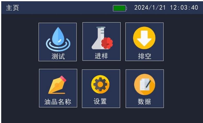
点击**测试**开始测试，显示当前颗粒数量以及水分、温度、运动粘度、水活性、介电常数、密度、含水率。检测结束会保存数据以及打印，如果在**加热测试下**，铁磁颗粒检测完毕后，温度值在达到40度后，才能结束检测；
