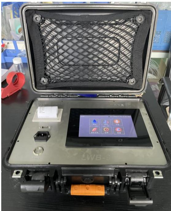
仪器内置锂电池，亏电状态下充满电需要2个小时，正常检测连续使用3-4个小时，加热检测可连续使用1-2小时；
