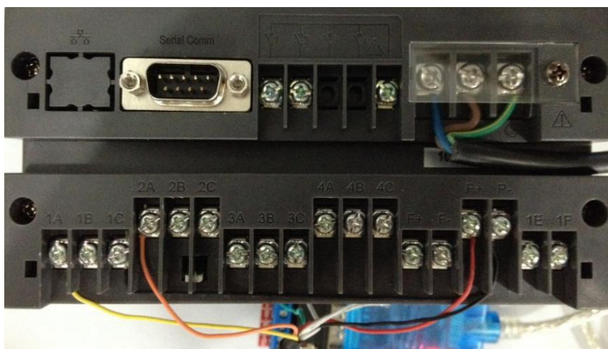
图 20 仪表端子与传感器电缆连接图
