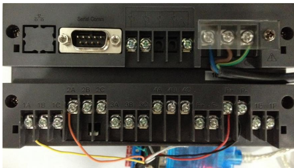
图 10 仪表端子与 S1000 电缆连接图
