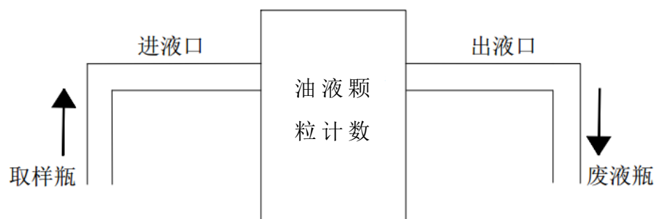
图 3.3.2 仪器离线安装方式示意图
