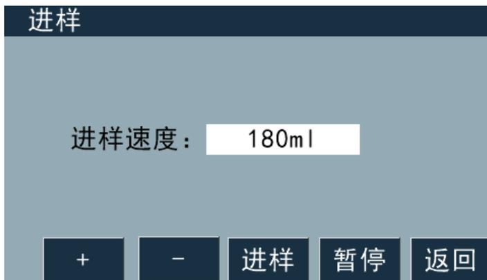
**进样设置**用于仪器管路内部空置时吸油使用，吸油至仪器内部管路充满，流出液口流出油液即可；
