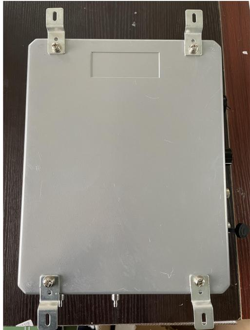
通过仪器导轨的安装螺孔，将仪器固定到待测系统接口的附近，保证安装稳固、固定位置无剧烈震动。固定好仪器后，使用管路将待测系统接口与仪器的进液口进行连接，将排液口连接到废液池。
