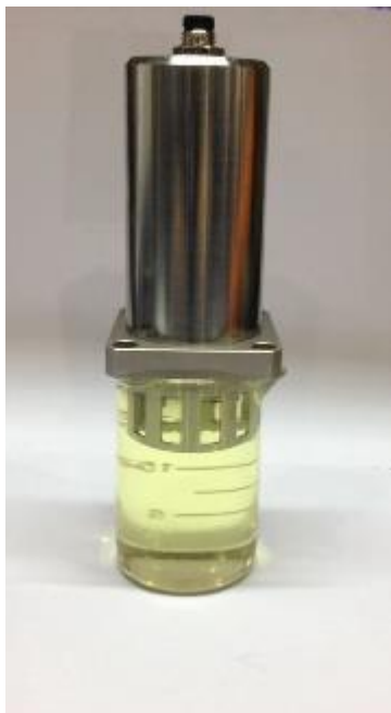
图 26 传感器探头放置位置示意图
