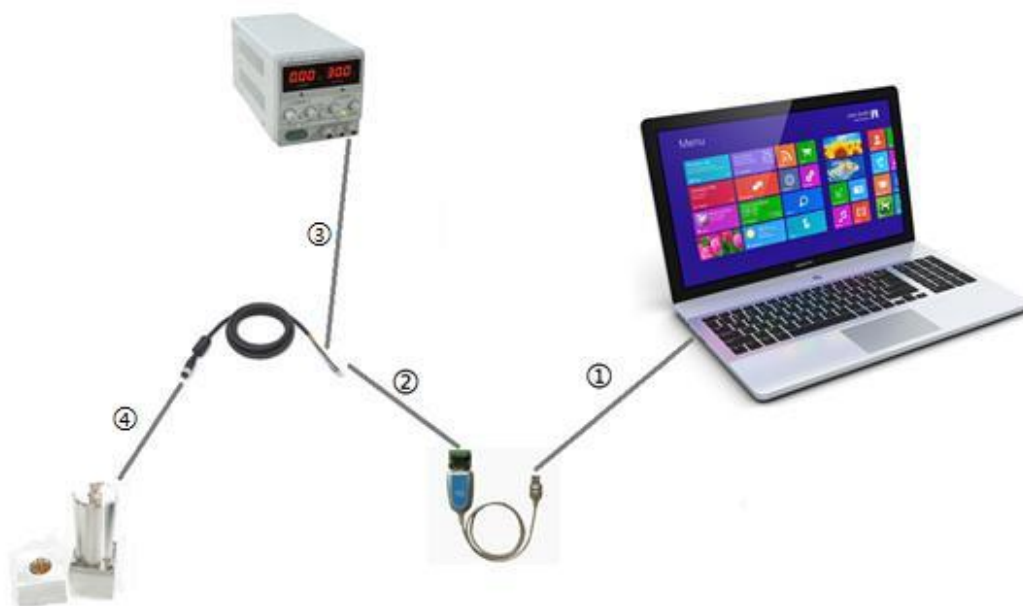
图 9 测试线路连接示意图
