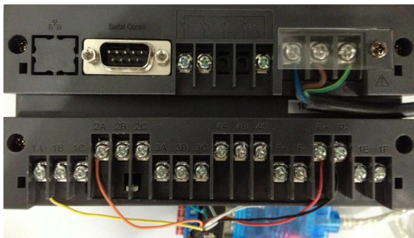
图 21 仪表端子与传感器电缆连接图
