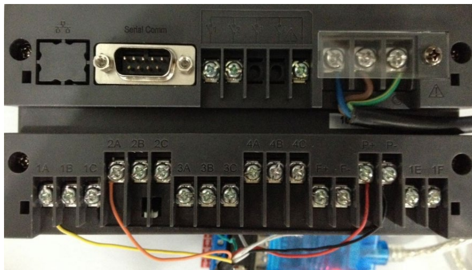
图 10 仪表端子与 HWR330B 电缆连接图
