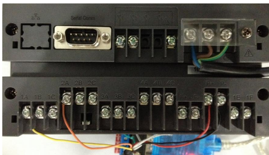
图 10 仪表端子与 HWR350 电缆连接图
